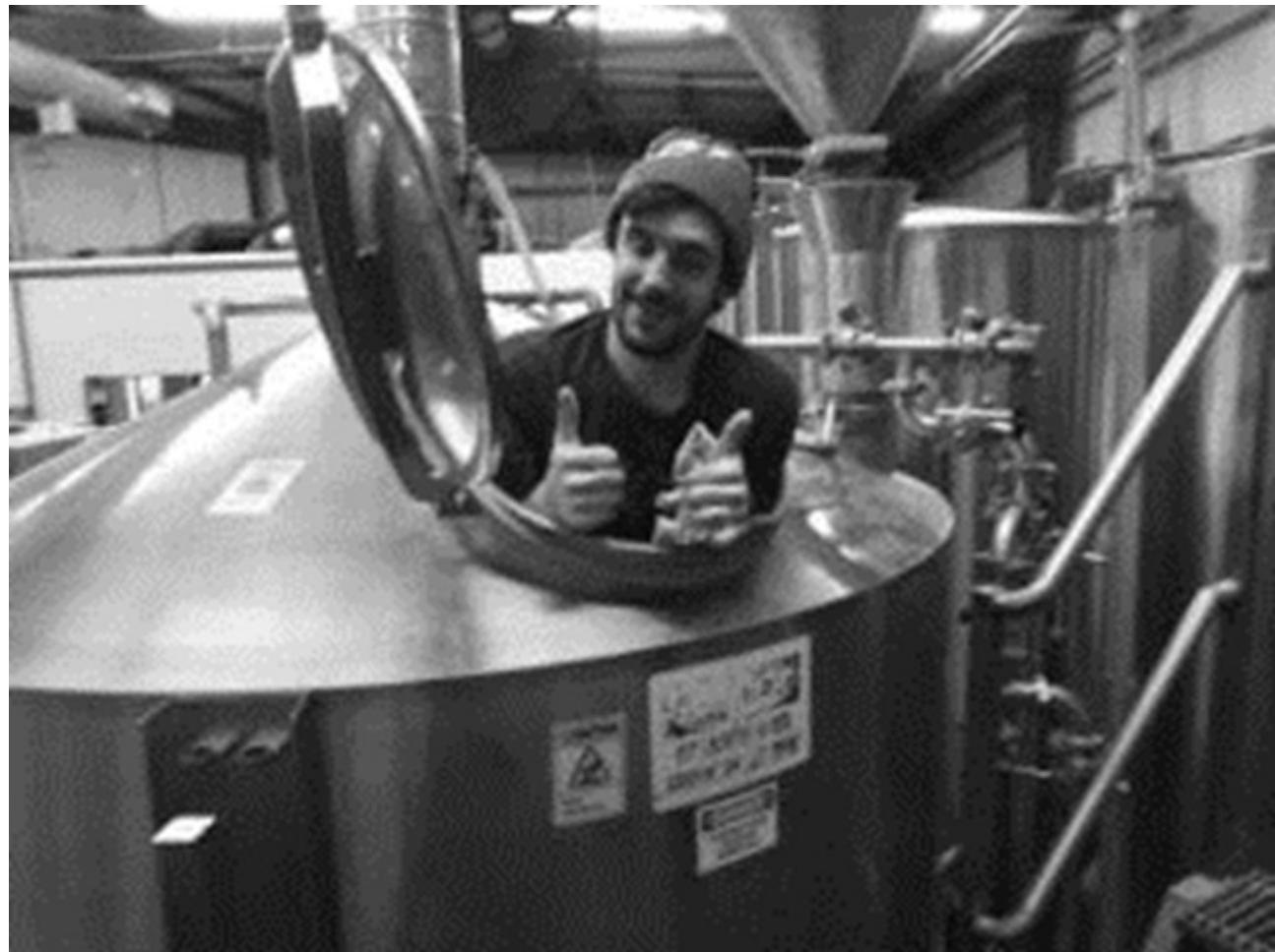
**¿Qué hay de malo en esta foto?** La asfixia es la principal causa de muerte en espacios confinados. Un espacio confinado con permiso puede contener una atmósfera peligrosa debido al desplazamiento del oxígeno por los subproductos de la fermentación de la uva durante el proceso de fermentación, cuando el azúcar se convierte en agua, alcohol y dióxido de carbono.
