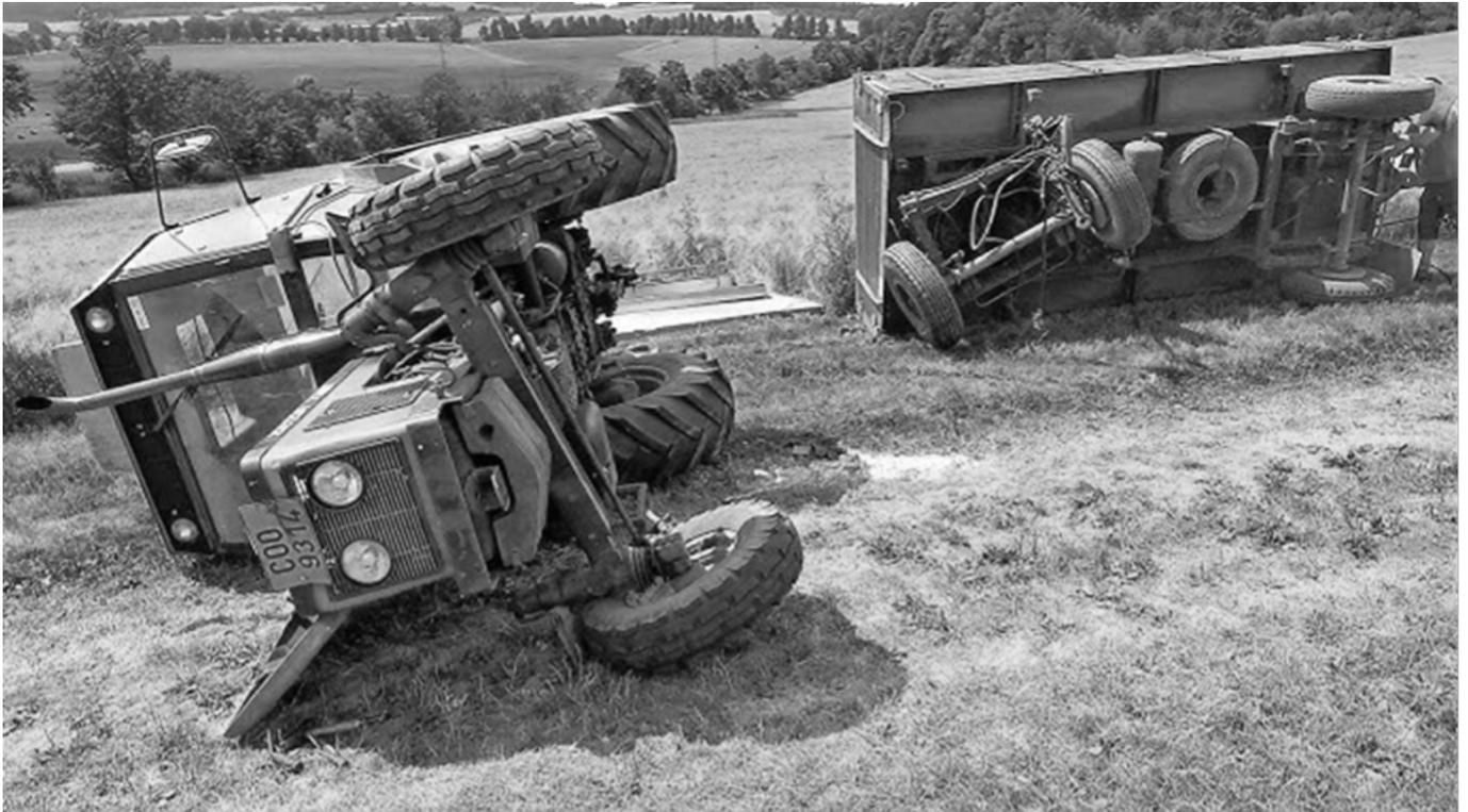
Le renversement du tracteur et de la remorque suggère une défaillance de l'attelage ou un mauvais équilibre de la charge pendant le fonctionnement. Cela indique que l'attelage n'était pas correctement fixé ou que le terrain et la pente n'avaient pas été correctement évalués au préalable. De tels incidents de renversement présentent des risques graves de blessures ou de décès pour l'opérateur et d'endommagement de l'équipement.
