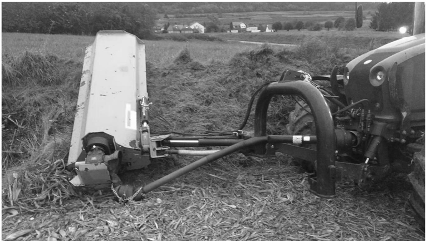
L'arbre de prise de force (PTO) fonctionne sans protection complète, laissant les composants rotatifs dangereusement exposés. Cela crée un risque sérieux d'enchevêtrement pour toute personne travaillant à proximité de la machine, en particulier lorsque des vêtements, des membres ou des objets lâches peuvent être rapidement happés. L'absence de protection enfreint les pratiques de sécurité de base pour l'utilisation d'équipements agricoles.
