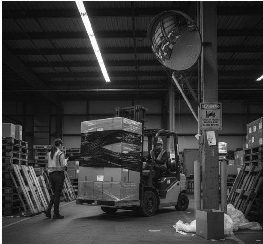
La vue vers l'avant du conducteur du chariot élévateur est complètement obstruée par une charge surdimensionnée, et un piéton marche directement dans l'angle mort du chariot élévateur sans établir de contact visuel ni s'assurer que le conducteur l'a vu. Malgré la présence d'un miroir convexe et d'un panneau d'avertissement, la disposition et le comportement créent un risque élevé d'accident par collision.
