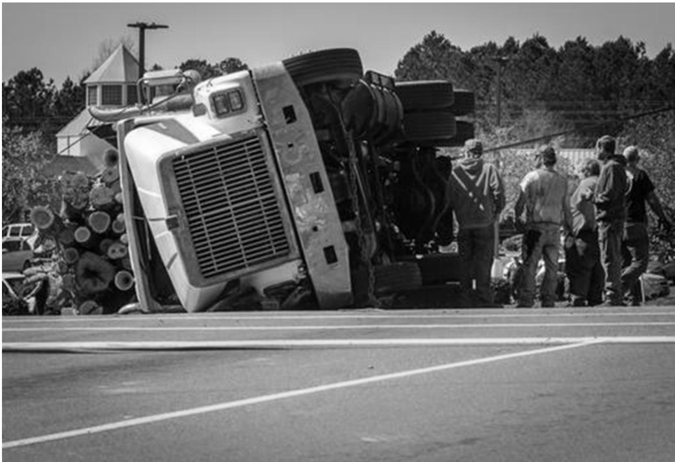
El camión volcó mientras transportaba una carga de troncos, y muchos de ellos se derramaron sobre la carretera. Esto indica que es posible que la carga no estuviera bien asegurada o equilibrada, lo que creó una situación peligrosa. La carga suelta o desplazada durante el transporte puede afectar la estabilidad del vehículo, aumentar el riesgo de vuelcos y representar un peligro mortal para el conductor y otras personas en la carretera.
