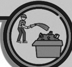
Riega los escombros de forma regular y no los acumules en los forjados, utiliza tolvas o canaletas.
